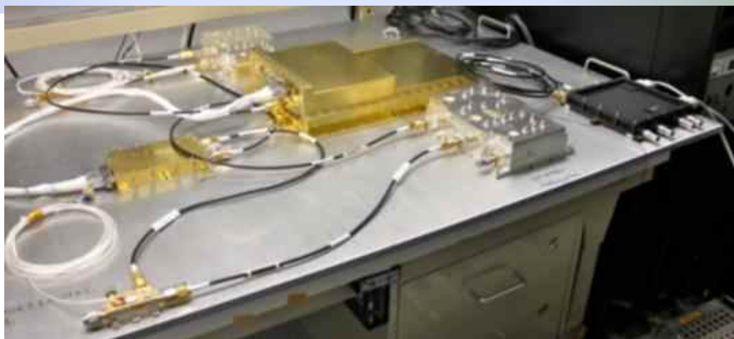
EM Radiometer RF Electronics Assembly (RRE)
